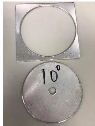
(圖九) 10 度前隙角車刀進行鑽削
