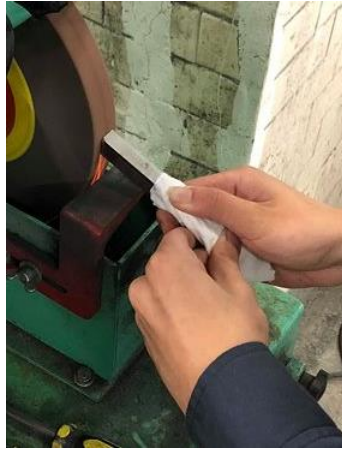
(圖六) 刀具前隙角的磨削
