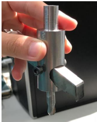
(圖五) 翼型刀及切削測試
