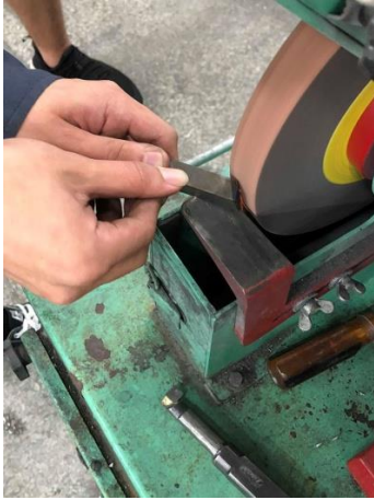
(圖六) 刀具前隙角的磨削
