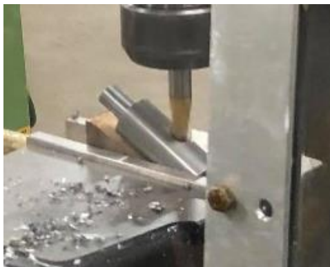
(圖三) 刀柄上鑽孔
