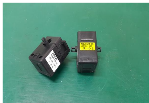
圖八 設備接線之電流感測器 (CT)
