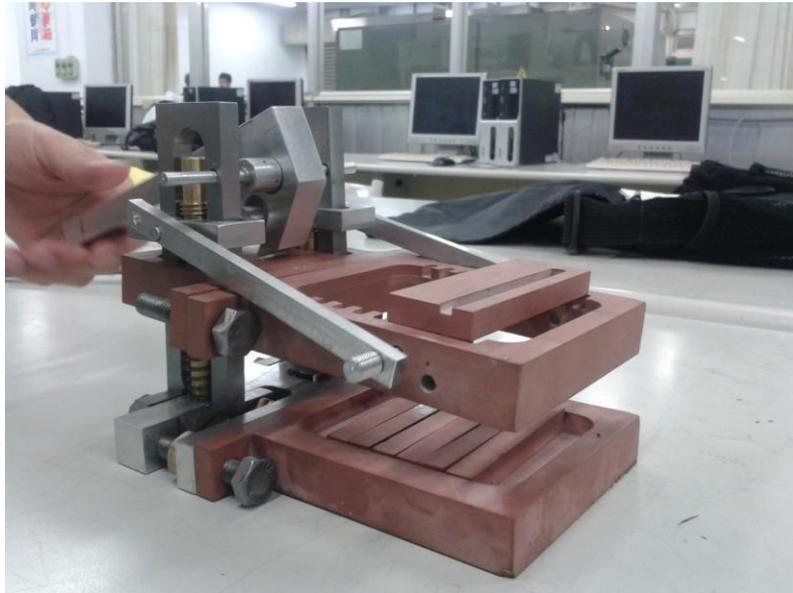
圖六 改良式的打洞機
