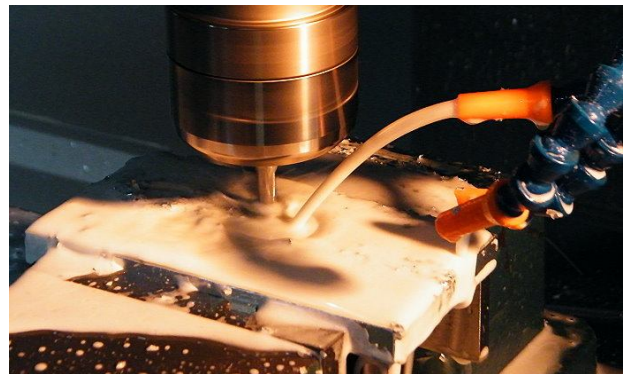
圖六 以 CNC 加工中心機精密挖槽
