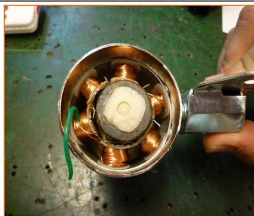
圖 7 腳踏車發電機解剖圖
