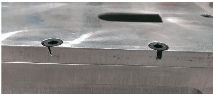
(圖五)板料破裂圖
