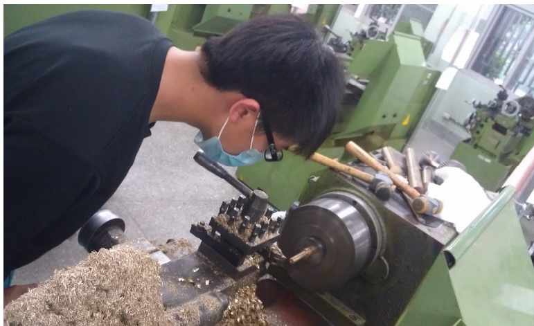
圖三 連桿軸的車製情形
