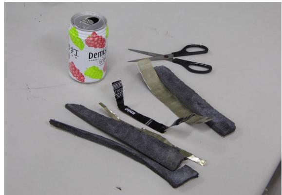
圖六 相同厚度的隔熱紙包覆進行夾持及所須工具
