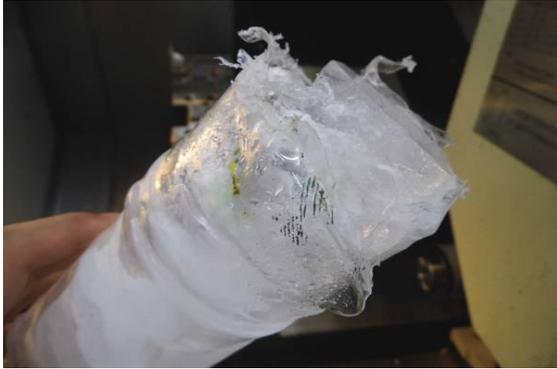
圖四 冰塊從夾爪上斷裂
