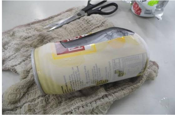
圖五 鐵鋁罐冰凍時產生破裂的情
