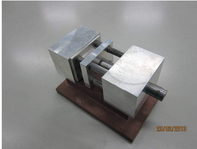
圖十一 手動式單孔射出成型機組合圖
