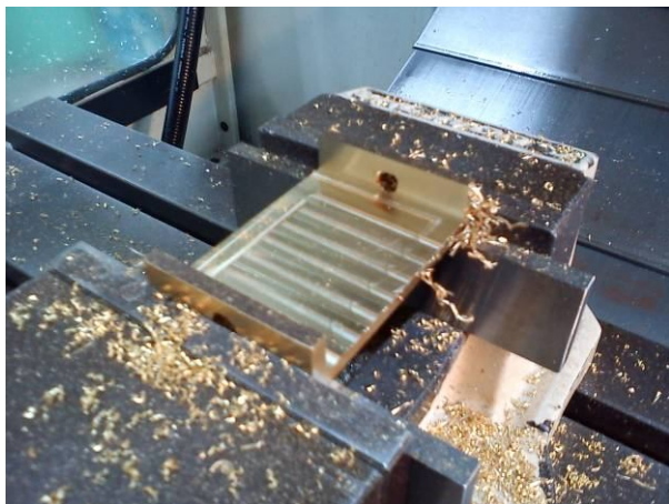
圖八 輔助架固定座的製作實況
