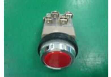
A push button switch with a red lens and a metal base with two screw terminals at the top.                        | <p>按鈕開關：<br/>有 a 與 b 接點，a 接點為常開接點，未按下按鈕時接點為 ON，按下按鈕時接點為 OFF，b 接點為常閉接點，未按下按鈕時接點為 OFF，按下按鈕時接點為 ON。</p>  |
