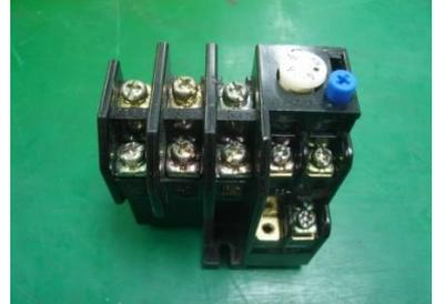
A thermal relay with a black plastic housing, multiple screw terminals, and a blue adjustment knob on top.       | <p>積熱電驛：<br/>又稱作為熱動繼電器、積熱繼電器，是利用雙金屬片作為過載保護，當發生過載時，因雙金屬片熱膨脹係數之不同，受熱後會朝一個方向彎曲，使接點被頂開，而發生斷路，以達保護之目的。</p> |
