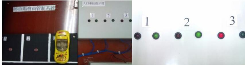
圖 46 停入車子後指示燈情形
