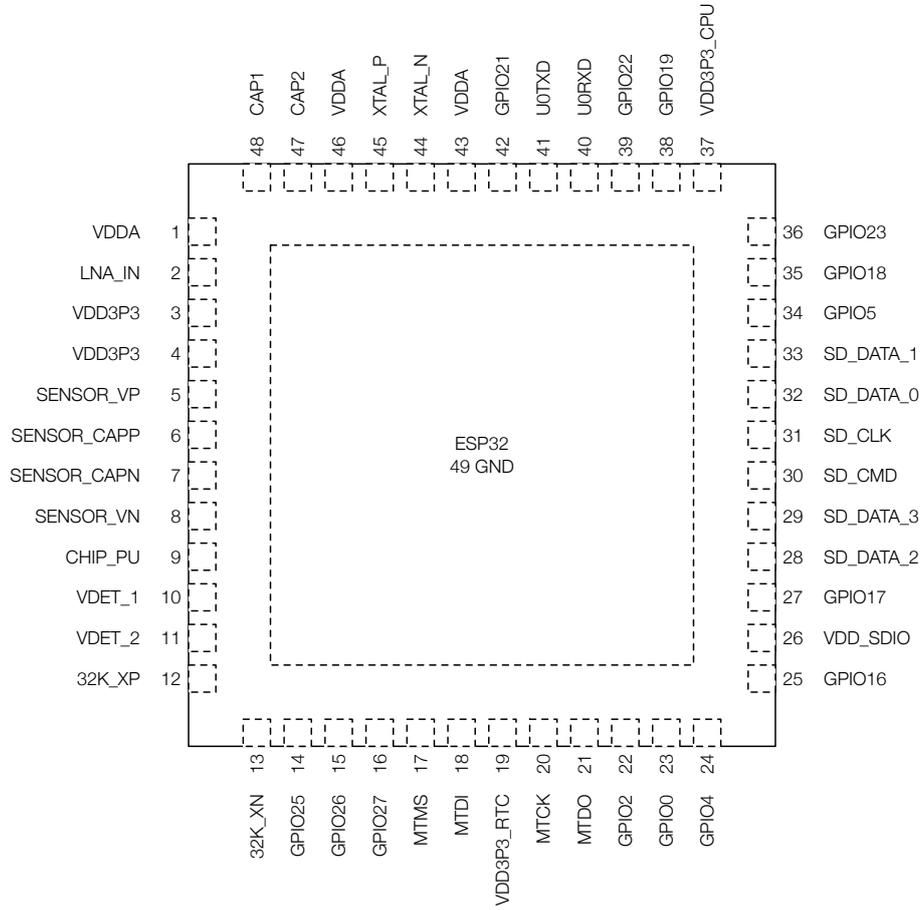
图 2: ESP32 管脚布局 (封装为 QFN 6\*6, 顶视图)
