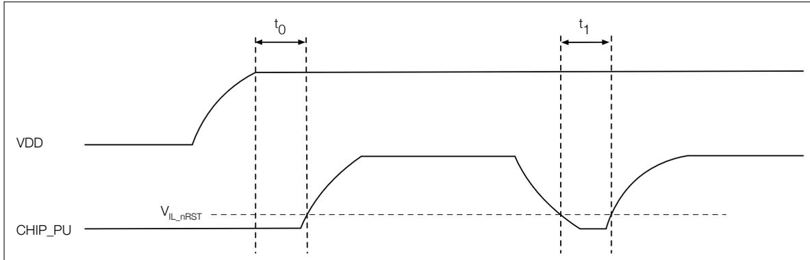
图 5: ESP32 上电、复位时序图
