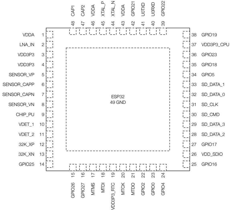
图 3: ESP32 管脚布局 (封装为 QFN 5\*5, 顶视图)
