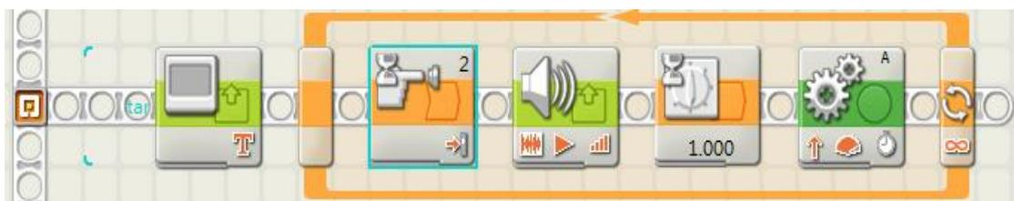
圖 8-程式流程圖-觸碰感應驅動迴圈
