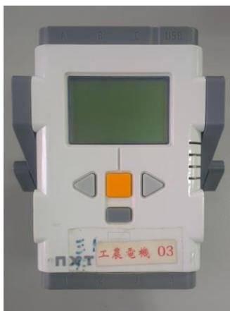
圖 2-NXT 樂高可程式控制器
