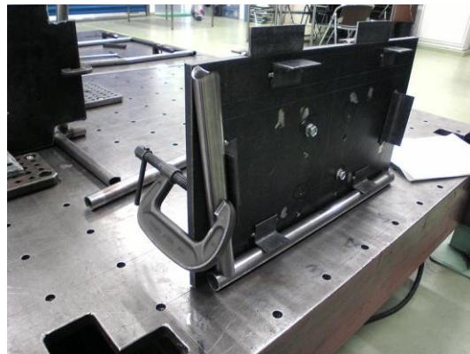
圖 2-1 定盤上固定治具類。
