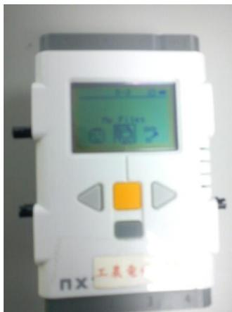
圖 3 NXT 樂高可程式控制器
