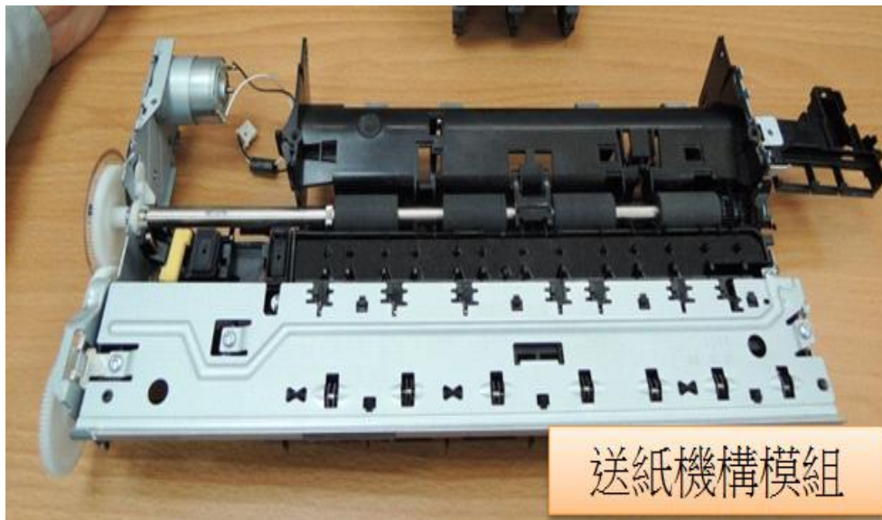
圖 (一) 影印機送紙機構之摩擦輪組及墨水匣組
