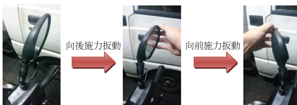
圖 4 傳統式後視鏡回彈試驗
