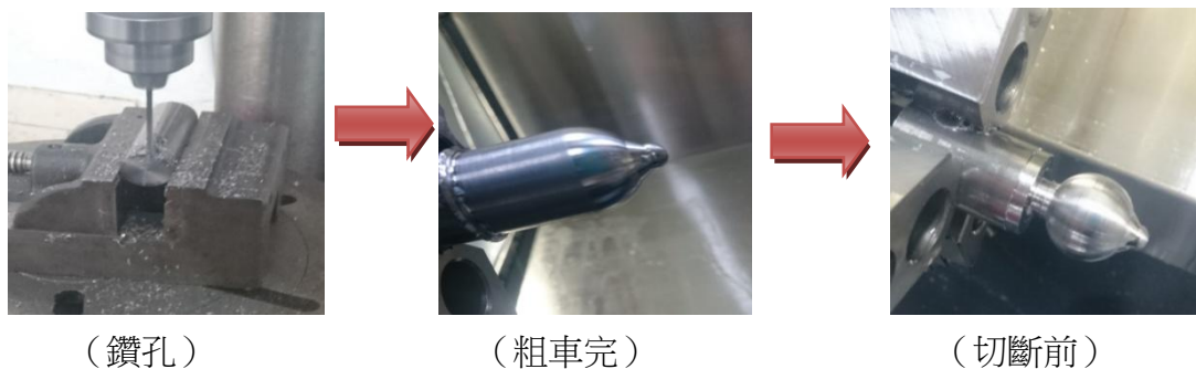
圖 9 球型連接器加工
