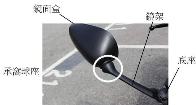
圖 2 傳統後視鏡的構造
