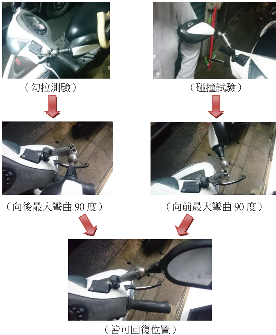
圖 12 可回彈式後視鏡勾、碰測試
