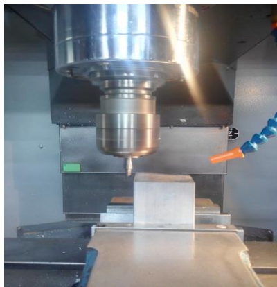
圖七 CNC 銑床上的校刀工作
