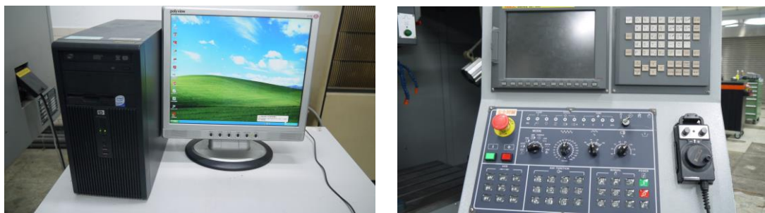
圖七 將模擬圖形轉換成 NC 程式並上傳至 CNC 銑床模擬器內
