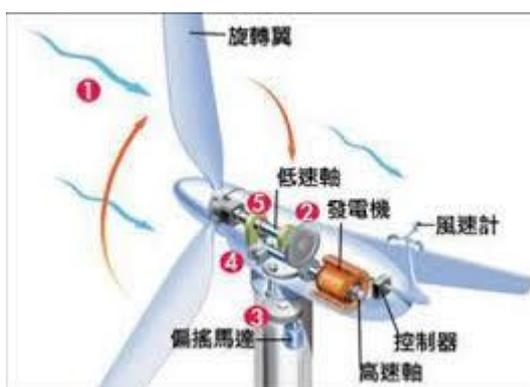
圖一 風力發電機構造（資料來源：造生能源資訊網）
