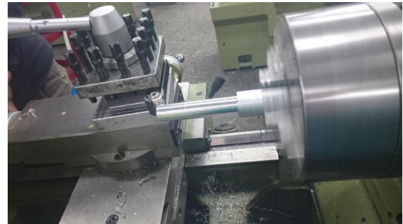
(圖五) 鋁合金連接棒之製作
