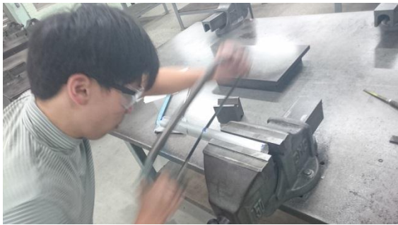
(圖五) 鋁合金連接棒之製作
