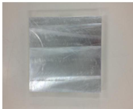
(圖 8)將尺寸銑削 100x98x15mm
