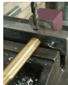
(圖九) 配合磁鐵進行鑽孔
