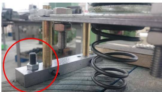
(圖六) 輔助軸與固定器和底板的接合
