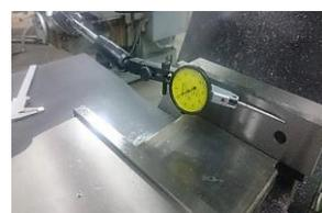
圖 23 量表校正銑床床台與主軸垂直度
