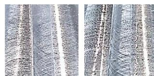
圖 27 左圖為全新端銑刀之銑削面，右圖為研磨端銑刀之銑削面
