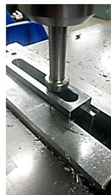
圖 20 運用倒角銑刀進行直狹槽倒角
