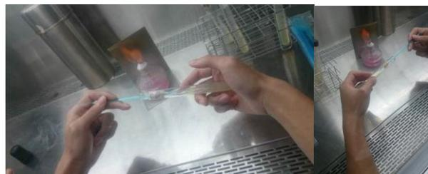
圖五：(左)利用接種環刮出大腸桿菌(右)Z 字塗在新的斜面培養基上
