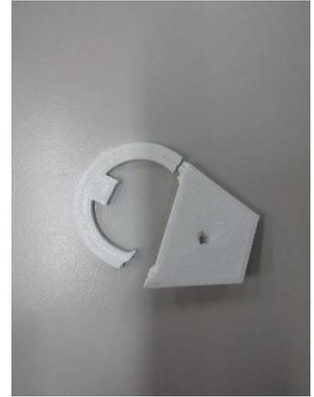
圖十三、斷裂的開罐器
