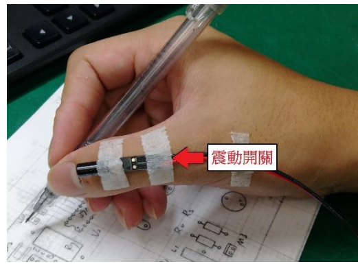
圖十四：手部震動開關實照 (圖十四資料來源：研究者拍攝)
