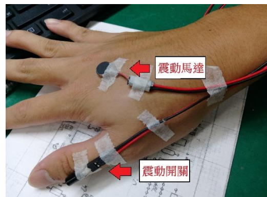
圖十六：手部震動開關以及震動馬達實照 (圖十六資料來源：研究者拍攝)
