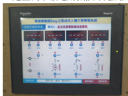
圖 12、直流串激電動機接線實驗 (資料來源：本研究拍攝)
