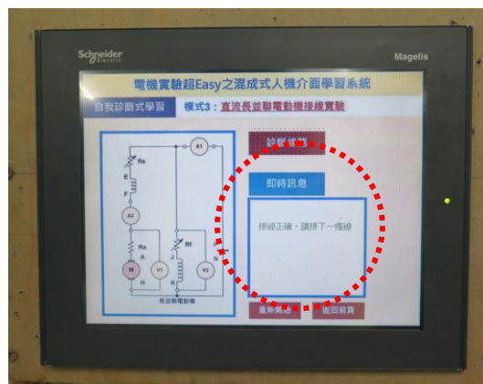
圖 20、人機顯示「接線正確」資訊 (資料來源：本研究拍攝)
