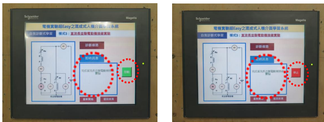
圖 21(左)及圖 22(右)、人機畫面顯示「完成直流長並聯電動機接線實驗」資訊 (資料來源：本研究拍攝)
