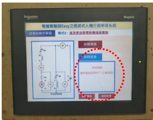
圖 19、人機顯示「接線錯誤」資訊 (資料來源：本研究拍攝)
