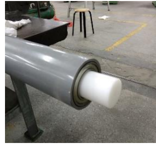
圖 25 固定軸與滾軸相配合
