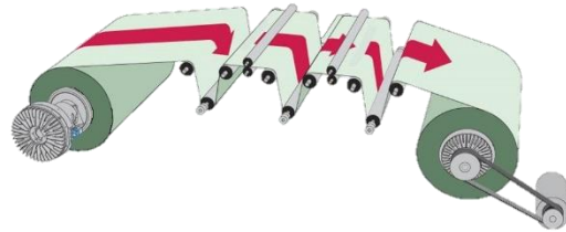
圖 13 複捲機張力控制示意圖
