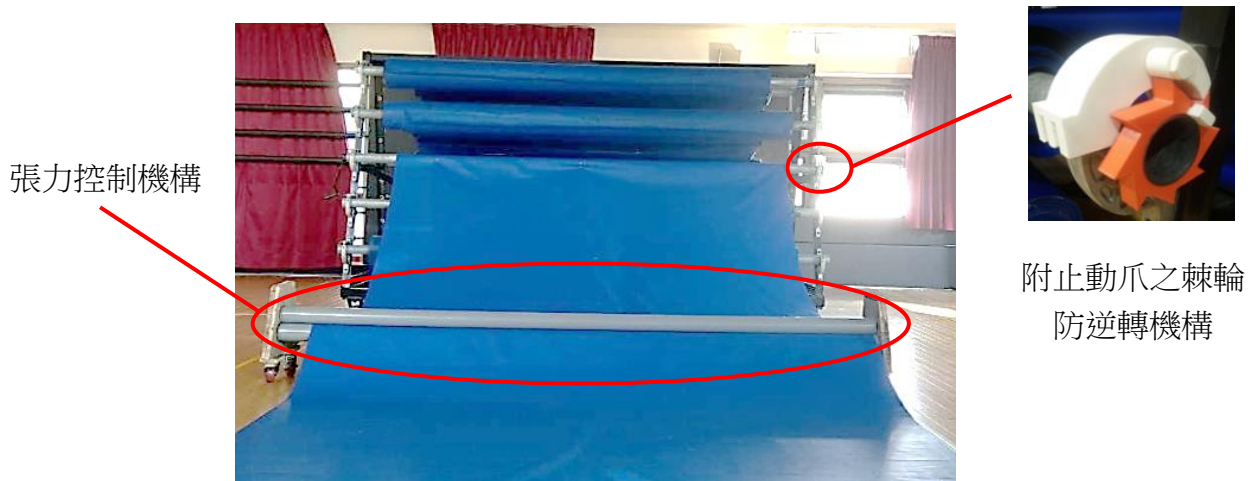
圖 18 捲布機安全輔助機構裝置完成圖
