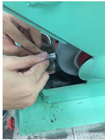
圖六 以砂輪機研磨管件毛邊
