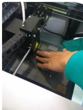
圖(十五) 水平校正
