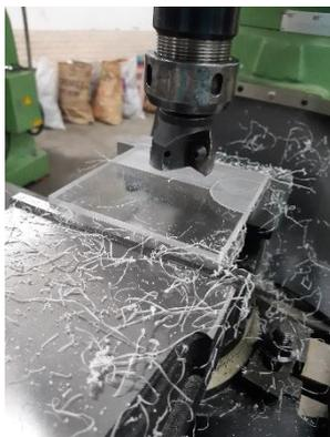
圖(十一) 銑削外型尺度
