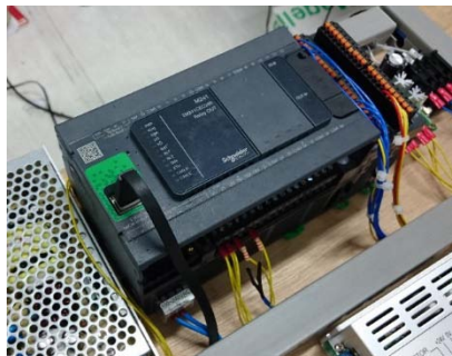
圖(25) 施奈德 PLC
