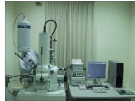
場發射掃描式電子顯微鏡
